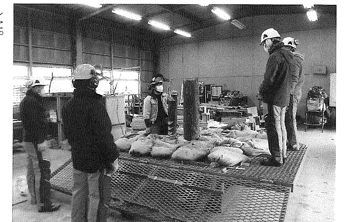
伐倒練習機を使用した研修の様子 一つの丸太に複数の受口を作り練習しました、丸太の入替も簡単に出来ます。
